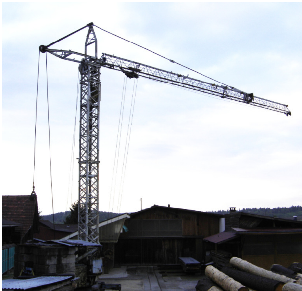
Richier Weitz Schnellmontagekran X 1060 mit 20 m Ausladung und 23.5 m Hakenhöhe.
