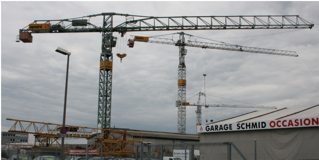
GT 1295 S 1 mit 12 t Ausrüstung für 4-fache Einscherung.
