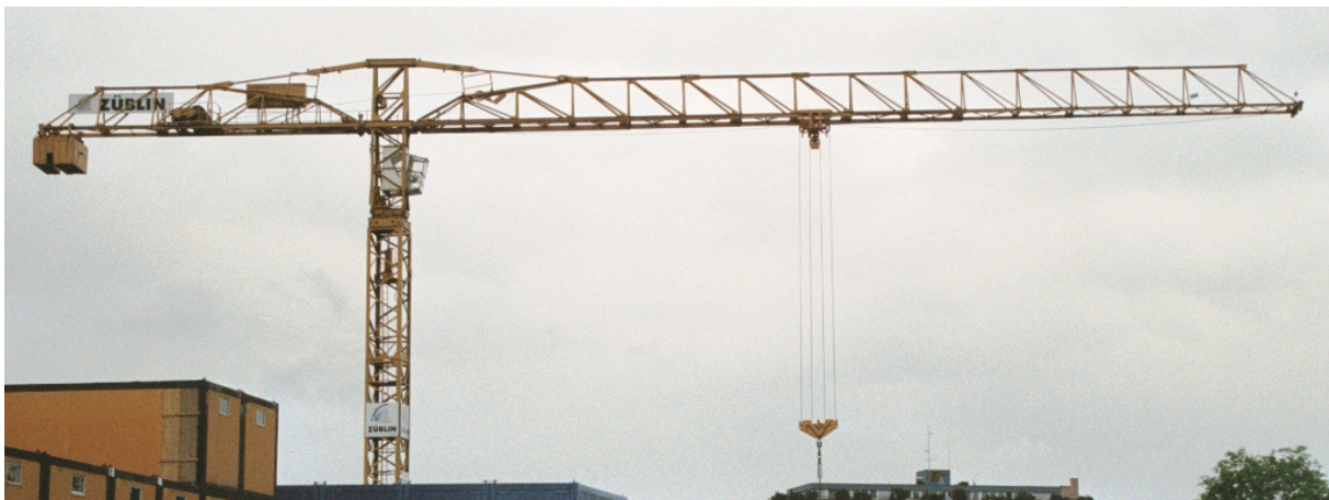
GT 1295 S 1 mit 12 t Ausrüstung für 4-fache Einscherung.
