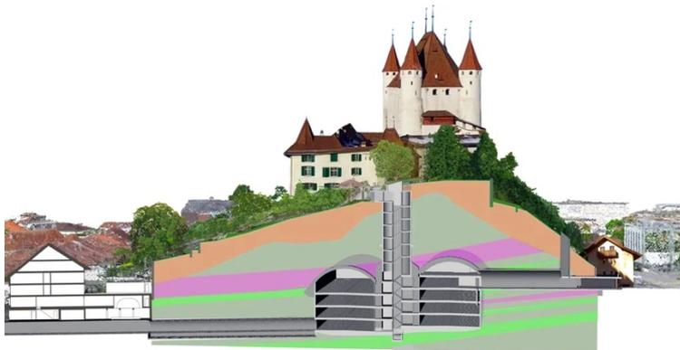
*Ein colorierter Schnitt mit den geologischen Zonen. Rechts ist die Ein- und Ausfahrt beim Kreisel an der Burgstrasse. Links gibt es einen Ein- und Ausgang für Fussgänger an der Oberen Hauptgasse. Ein Lift und eine Treppe führen auf den Schlossberg.*
