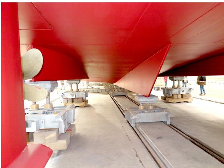
Blick unter das frisch revidierte Schiff «Berner Oberland» mit den genau platzierten Böcken, auf denen es stand. Das Foto oben wurde am Tag der offenen Türe gemacht. Links ist eine der Schiffschrauben und dahinter eines der Ruder.
