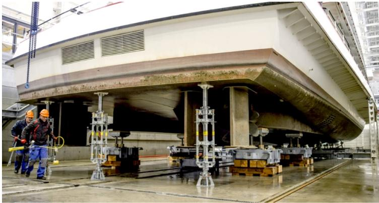
Das Schiff «Berner Oberland» nach dem Abpumpen des Wassers im Trockenbecken und dem gezielten Aufbocken. Man sieht den Dreck am Unterwasserschiff (rot lackiert).
