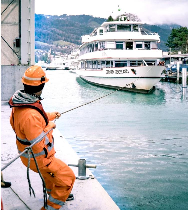
Die ausgeschalteten Schiffe werden aus Sicherheitsgründen mit Seilen in die Halle gezogen. Dies da die Lücken links und rechts vom Schiff relativ klein sind. Die Zugkraft ist bei einem leeren Schiff und minimaler Geschwindigkeit und zwei Männern genug gross. Ein Taucher muss Bescheid geben, ob das Schiff korrekt über den Böcken steht.
