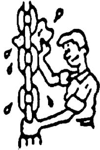
**Ketten regelmässig reinigen, damit defekte Stellen sichtbar werden.**
