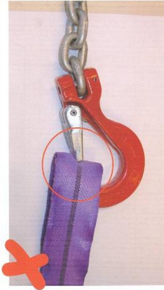
Hebeband nicht korrekt eingehängt
