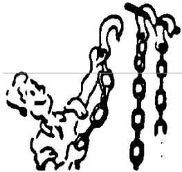
**Bei der Lagerung Ketten vertikal aufhängen, damit eine einfache Kontrolle möglich ist.**
