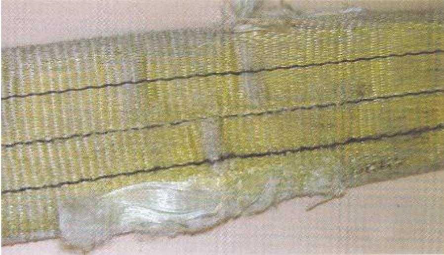
Längs- und Querschnitte, Beschädigung der Nähte. Scheuerstellen.
