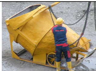
Betonkübel mit grossem Volumen für die liegende Befüllung mit Handrad zum Entleeren und Lasttraverse
