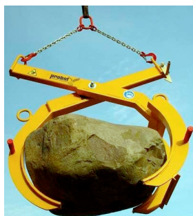
Manuell öffnender/ schliessender Greifer mit einem grösseren Stein als Last
