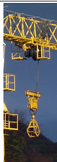
Automatisch öffnender/ schliessender Greifer an einem Liebherr 120 HC
