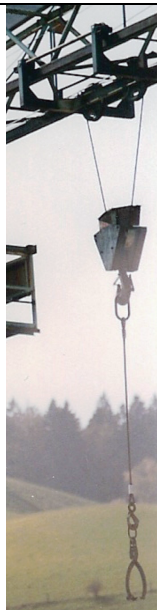
Manuell öffnender/ schliessender Greifer an einem Schwing KTK 75 U
