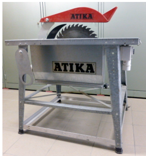
Eine Baukreissäge mit Schutzhaube (rot) und mit Alu Tisch
