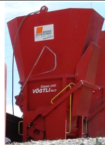
Kombinierter Betonkübel mit Zentral- sowie Seitenauslauf
