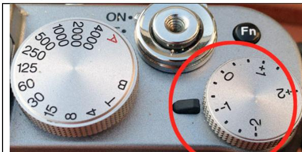
Indem man den Bildschirm der Fotokamera beobachtet, dreht man am Rädchen für die Belichtungskorrektur bis das Ergebnis am Bildschirm der Kamera stimmt.
