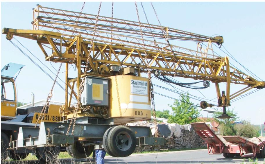
Der TK 5 wurde mit einem Pneukran gehoben und auf den Sattelschlepper verladen.
