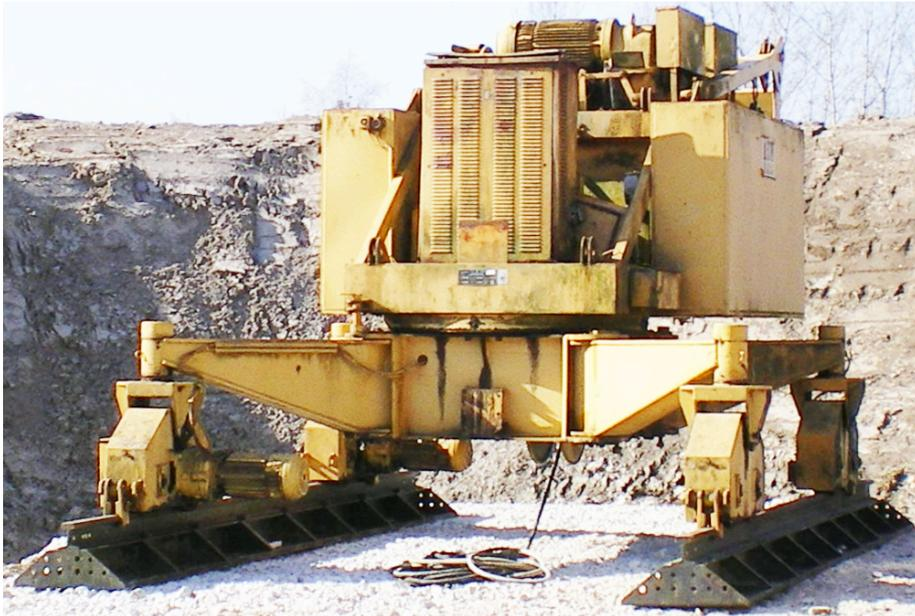
Der Unterwagen mit Drehbühne stand auf Schienen ohne Distanzhalter und ohne Puffer. Die Schienenzangen sind aber angezogen.
