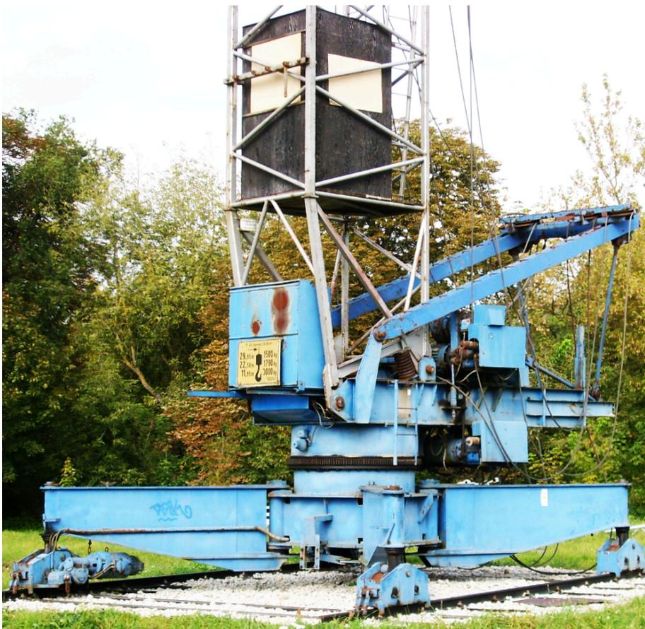
Den Turm des T 45 hat man provisorisch aufgerichtet. Das sieht man an den Schlaufseilen an der Drehbühne.
