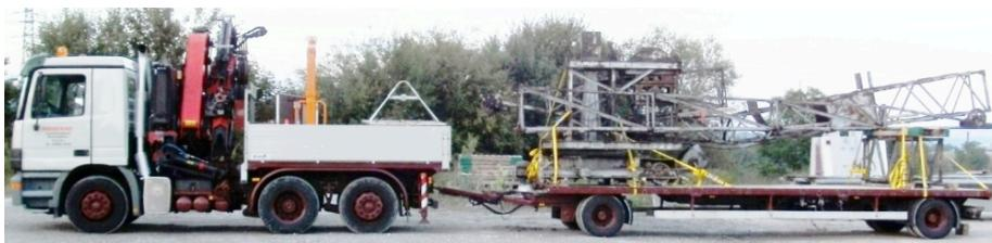
Der TK 6 beim Abtransport . Der Ladekran am LKW wurde bei der Demontage des TK 6 eingesetzt.
