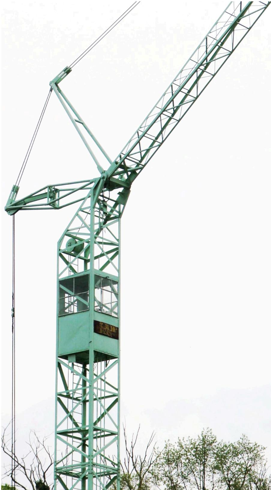
Die Ausleger-Anlenkung mit der Kabine und der Tabelle der Tragkräfte.
