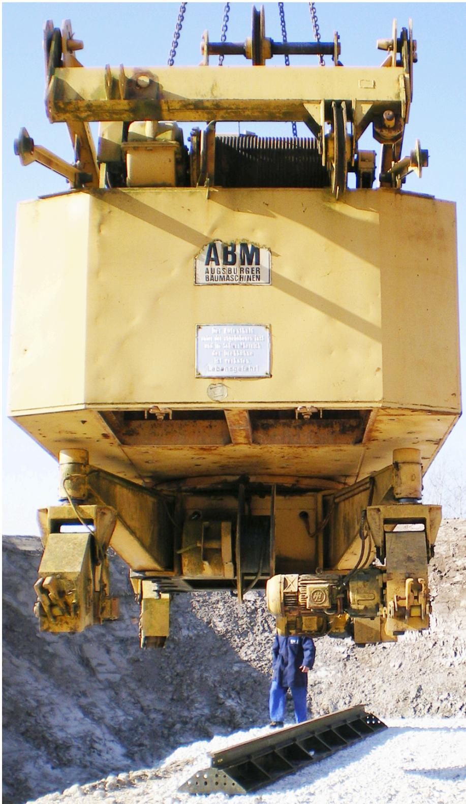
Der Unterwagen mit Drehbühne bei der Teilmontage mit Hilfe eines Pneukrans auf die Schienen.
