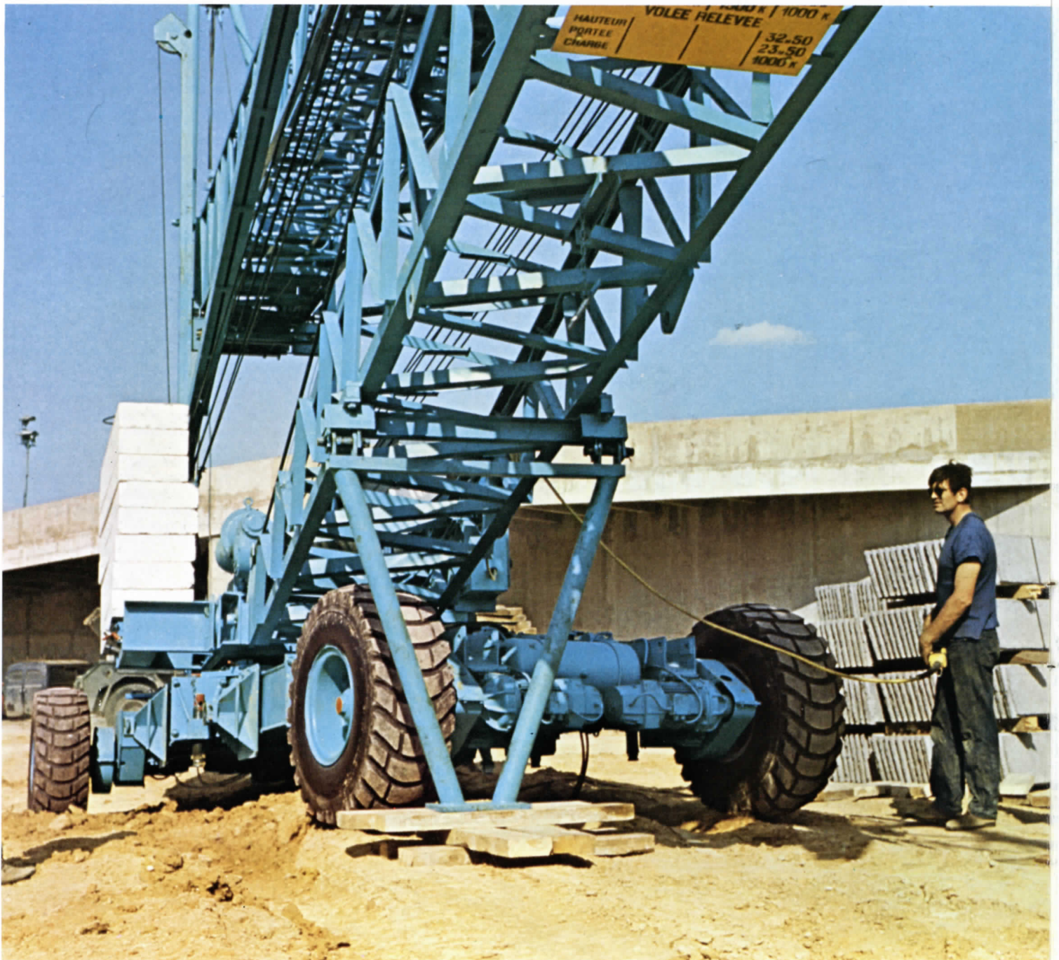
Abspindelung eines Krans: Sämtliche Arbeiten werden durch den Kran selbst ausgeführt.
