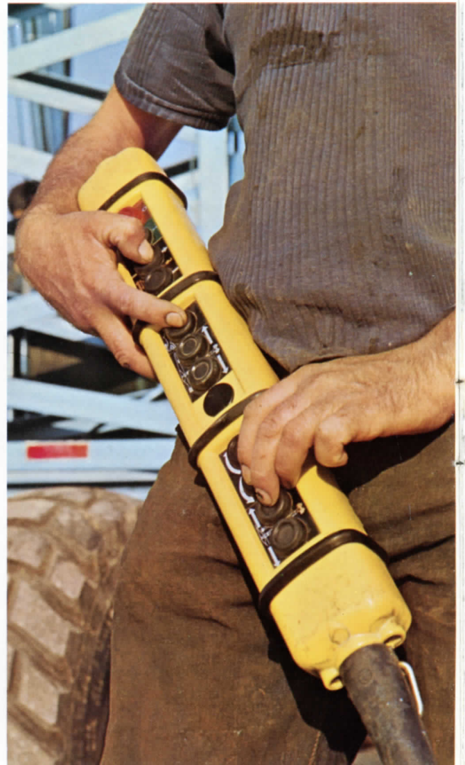
Der Steuerpult: Alle Bewegungen werden von hier aus getätigt.
