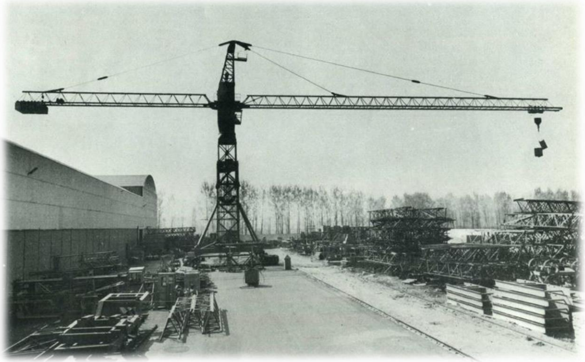
Schwerlast-Turmdrehkran LP 350 Probemontage im Werk Assago (MI)
